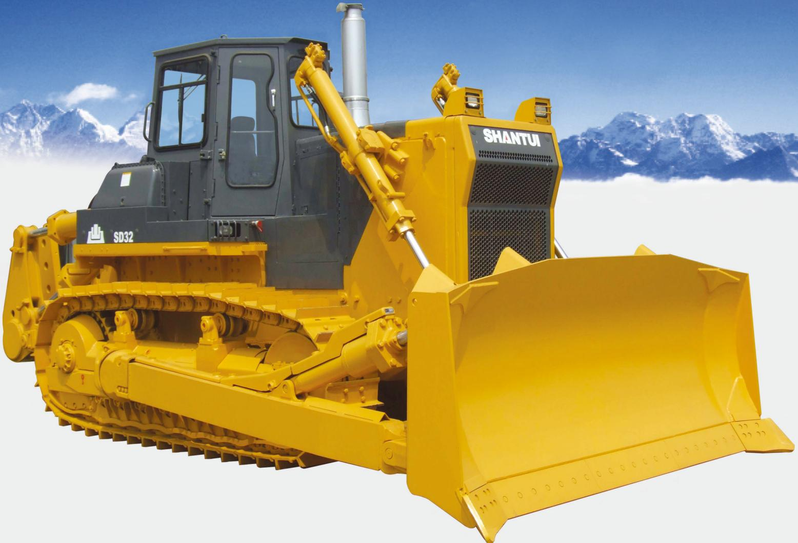
SD32推土机系引进日本小松制作所先进技术生产的大功率推土机，配用康明斯NTA855-C360S10发动机、功率大、油耗低，带有废气涡轮增压器，在海拔3600米的高原作业，不需作任何调整，仍能保持正常工作。整机采用先进的液力传动、液压操纵技术，结构先进合理，操纵轻便灵活，质量可靠。
